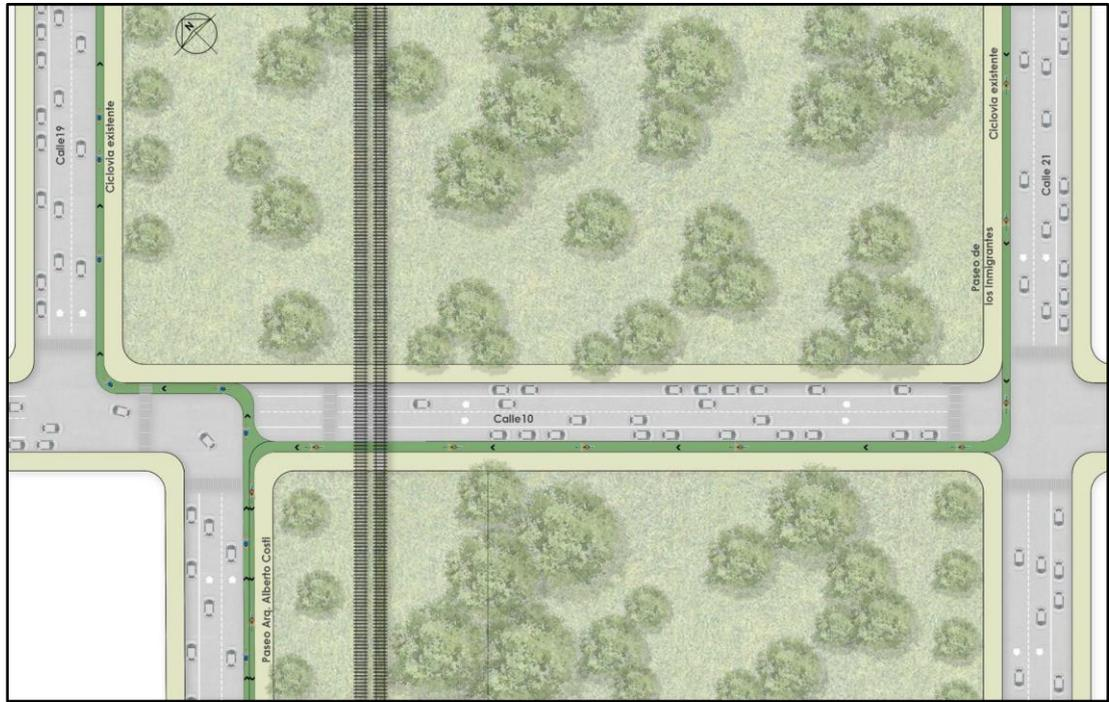
Para el circuito 19-21 se propone reutilizar las bicisendas existentes en el sector del microcentro, otorgándole un sentido a cada calle, conformando un circuito de ida y vuelta. Actualmente éstas se encuentran demarcadas con pintura en el pavimento, por lo que, se propone combinar esta pintura, con señalética, y reductores de velocidad para los vehículos, a fin de generar un recorrido seguro para los usuarios que utilicen esta bicisenda.
