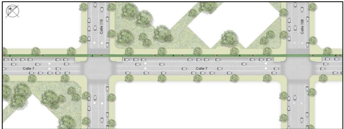
Sobre calle 7 oeste-7 entre a 112 a 40, el circuito comienza sobre calle 112 hasta 40, este tramo tiene igual sección, ya que la bicisenda toma solo un sentido de este a oeste. La idea central es igual que la 9 la bicisenda se plantea al ganar espacio sobre el estacionamiento existente. El diseño de cuadra y vereda remata en islotas o bioswales en las esquinas, como tope de estacionamiento, generando también un lugar para estacionamientos de bicicletas.
