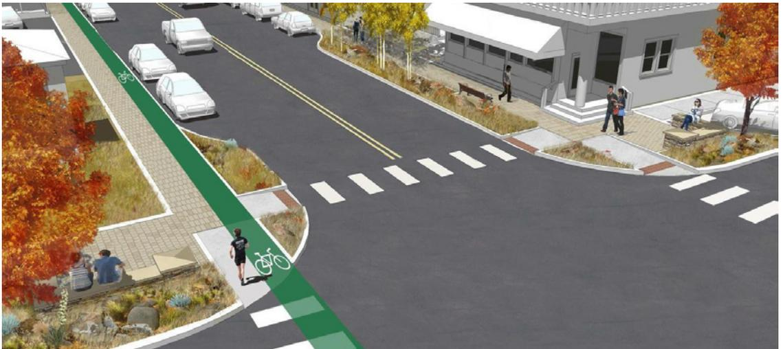
Sobre calle 9 oeste-9 entre 124 a 116, el circuito comienza sobre calle 124 hasta 116, este tramo difiere del resto, ya que la sección contiene 3 espacios ramblas y 4 carriles viarios. Como se ve en la planta, se decidió incorporar las biciesendas a cada lado dentro de la infraestructura existente de la rambla siguiendo con el sentido de los carriles laterales que son de tipo colectora vial.
